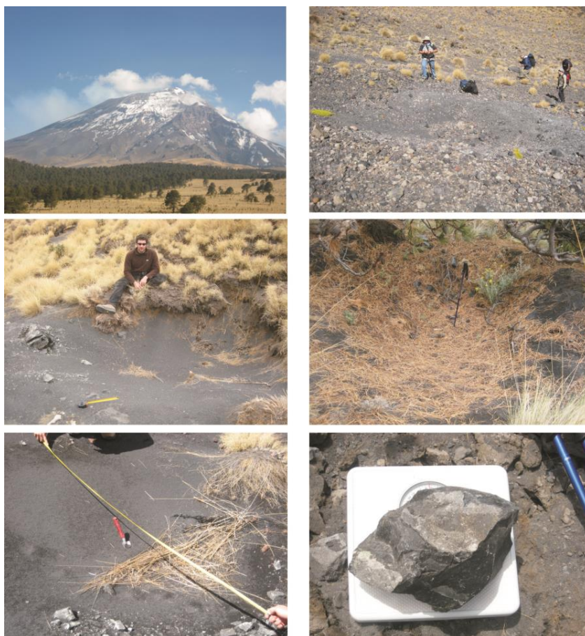
Figura 63. Fotografías del trabajo de campo realizado en el volcán Popocatepetl para identificar proyectiles balísticos. Los cráteres de impacto fueron localizados con GPS, se midieron sus dimensiones (abajo a la izquierda) y se pesaron los fragmentos de proyectiles balísticos encontrados (abajo a la derecha).
