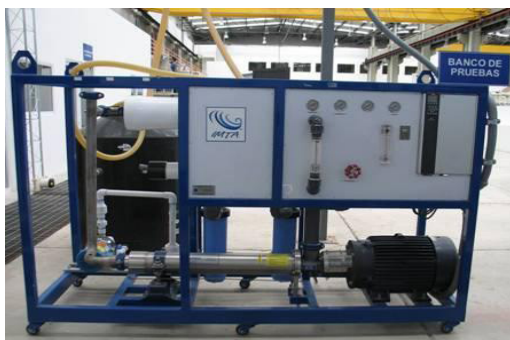
Imagen 4.1. Banco de pruebas de membranas.
